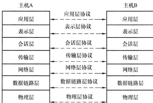
图 1-3 OSI 参考模型结构示意图
