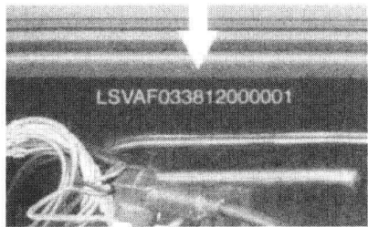
图 1-1 车架上的 17 位识别码
