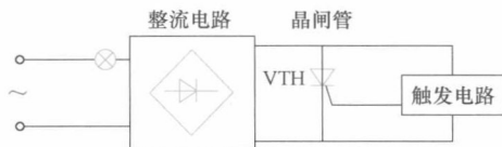
图 1-1-3 调光台灯电路的组成框图
