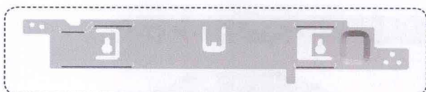
4. 冲孔落料 (创建拉伸切除)
