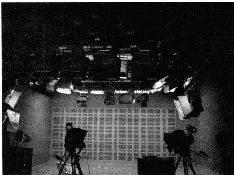
图 1-9 虚拟演播室摄像机跟踪技术之一——网格识别方式示意图
