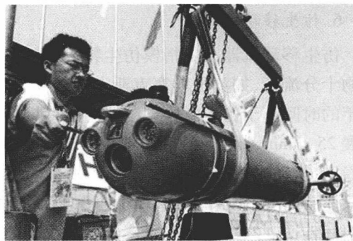
图 1.3 课题组在进行水下移动机器人模拟试验
