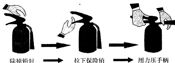
图 1-4 干粉灭火器的使用方法
