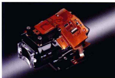
▲ 尼康D7100数码单反相机取景器构造图
