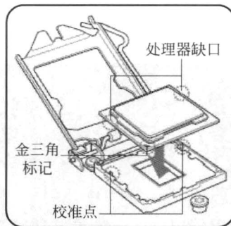
图 1-7 确认 CPU 与插槽对齐
