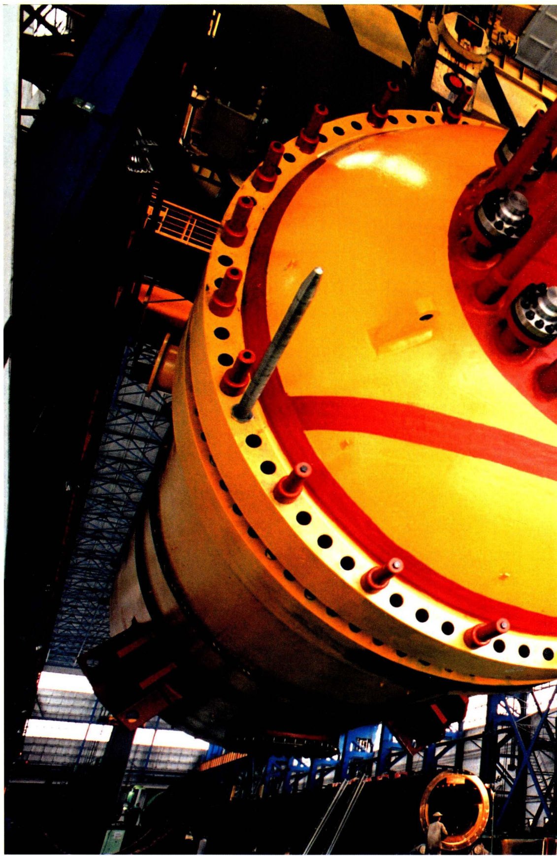
国家“863”计划重点项目：10兆瓦高温气冷试验堆的关键设备之一 —— 反应堆压力壳
