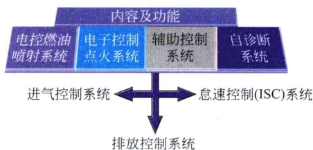
图1-2 发动机电控系统的控制内容及功能
