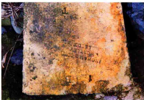
清溪铁厂耐火砖，产于英国，长31厘米、宽23厘米、厚10厘米。
