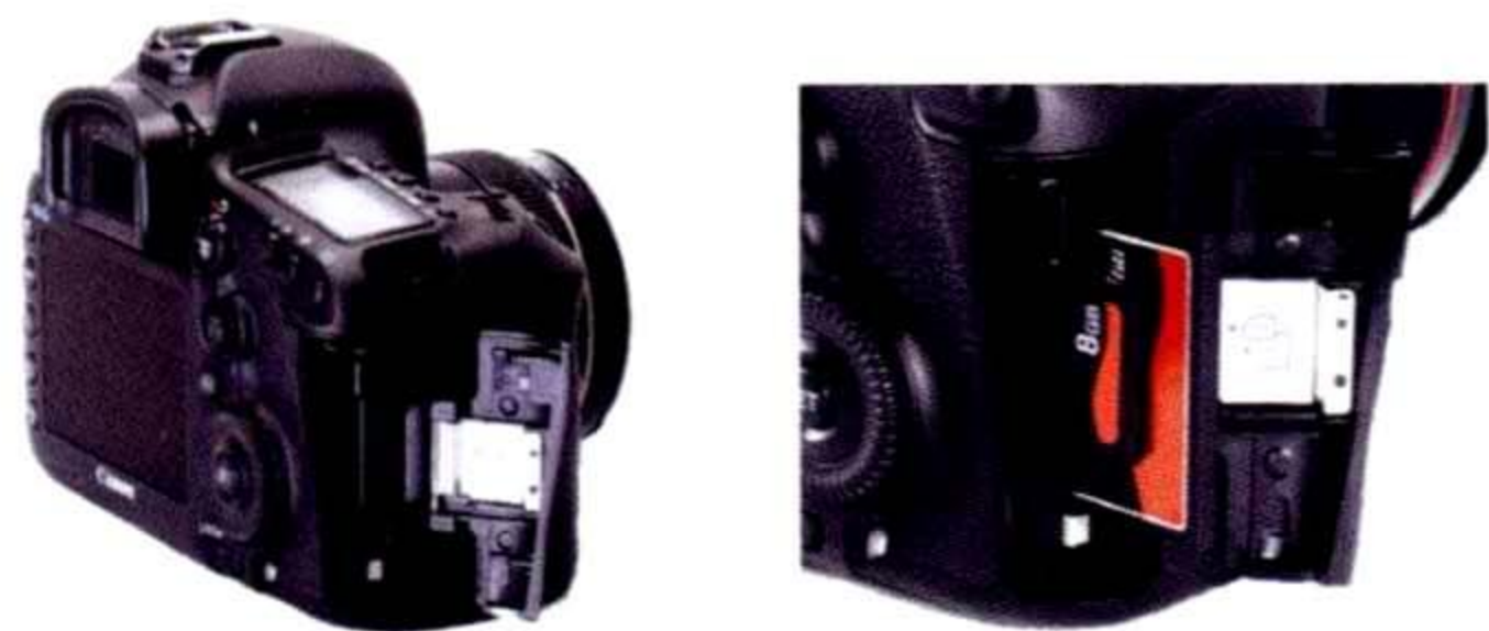
▲ 将5D Mark III的存储卡槽打开后可以看到两个并列的插槽，能够同时插入两张卡。
