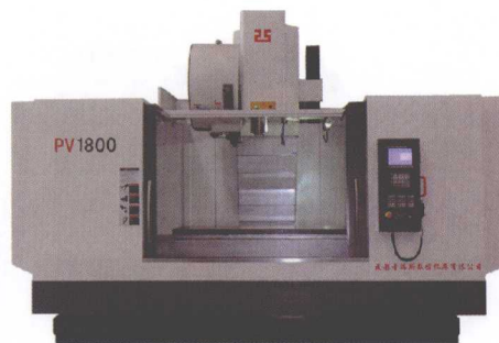
普瑞斯加工中心 PV1800 滑轨——凸轮式刀库
