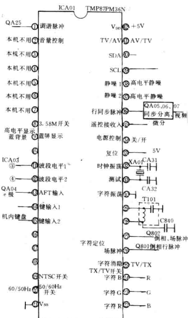
图 22 CPU 各脚功能及电平值
