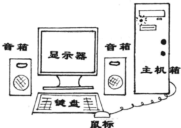
图1-4 多媒体计算机的基本组成
