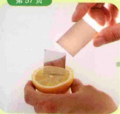
在柠檬之类的水果中插入金属板，就能产生电流。用水果制成电池，让发光二极管发出光来吧。
