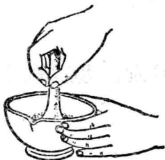
图9 把铁粉和硫粉放在研钵里研磨
