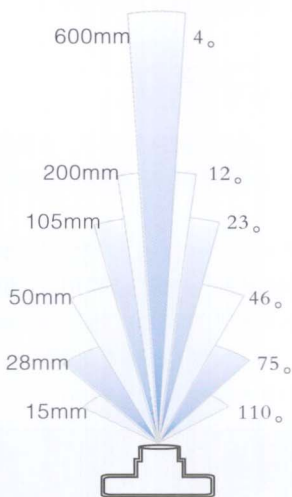
镜头焦距与视角关系示意
