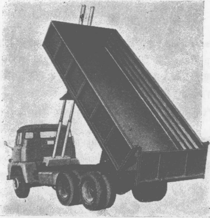
圖 4 具有 80^\circ 斜 角的 9 噸自 動傾卸車
