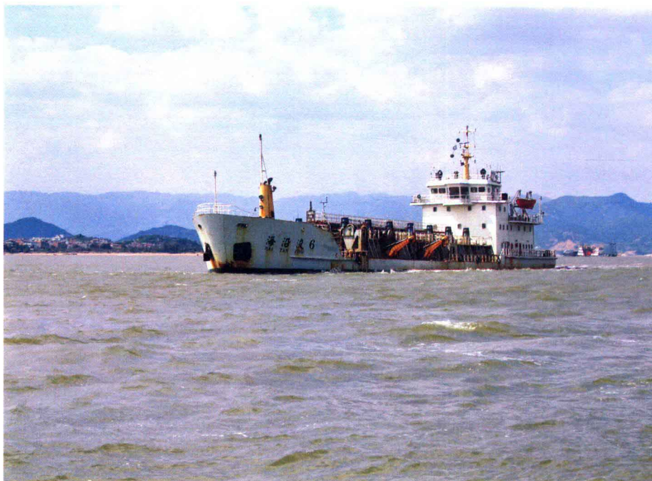
闽江口航道维护疏浚工程船舶
