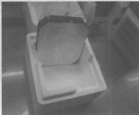
图 1-7 正在包装的硅片
