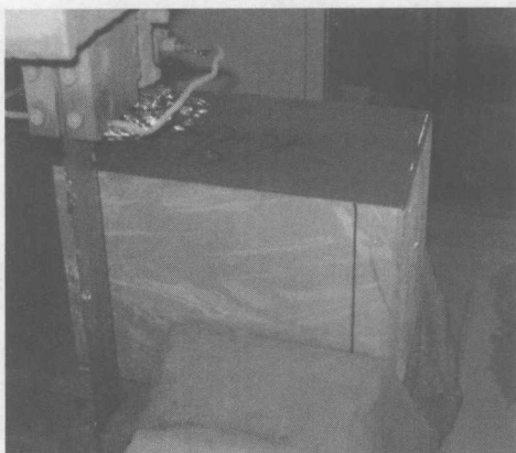
图 1-8 正在去头尾作业中的硅块
