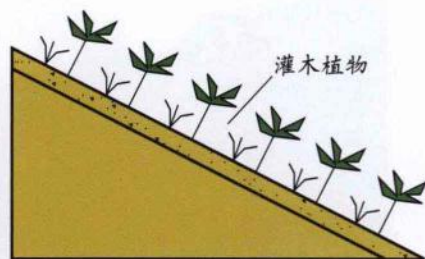
灌木植物为主护坡植被
