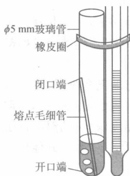
图 2-4 微量法测沸点装置
