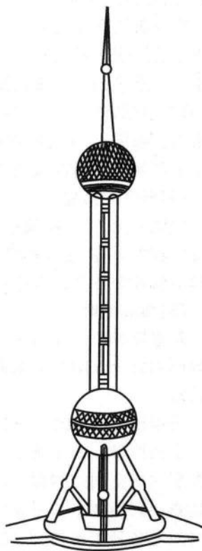
图 1-3 上海东方明珠电视塔 (总高 450 m)
