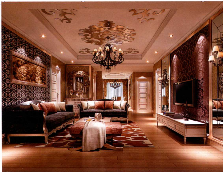
顶面 [ 石膏板造型 + 密度板雕刻喷银漆 ]
