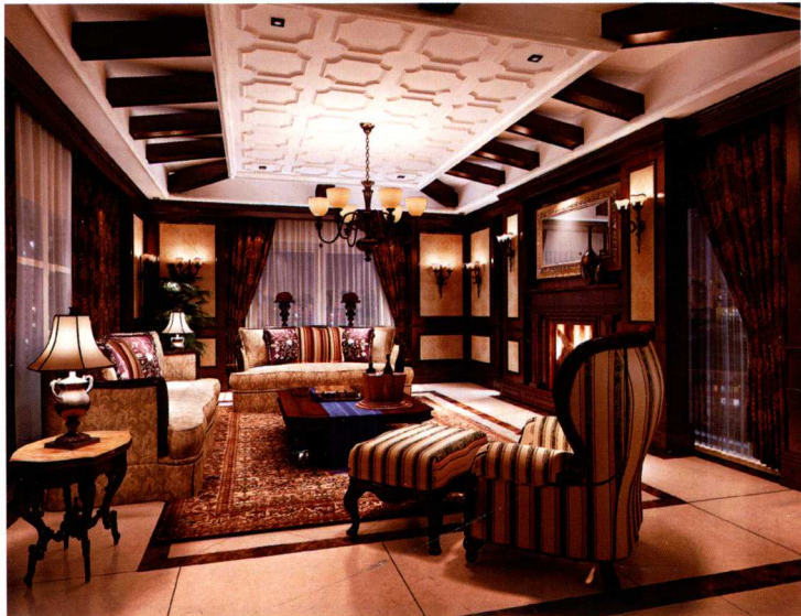
顶面 [ 木线条装饰框刷白 + 装饰木梁 ]
