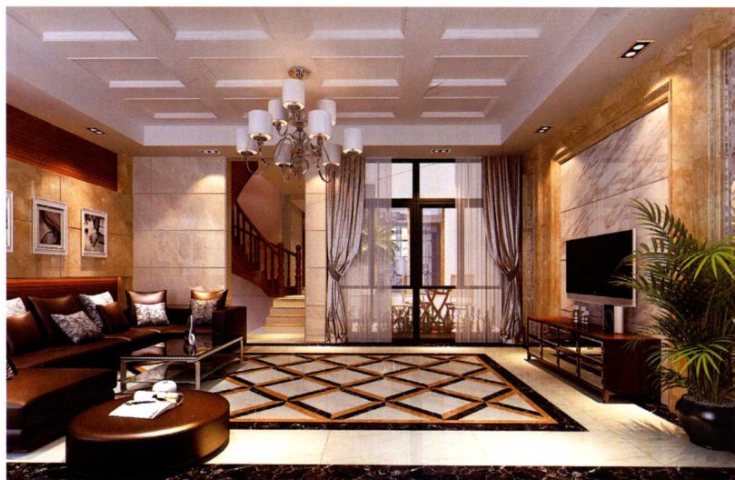
顶面 [ 石膏板装饰假梁 ]
