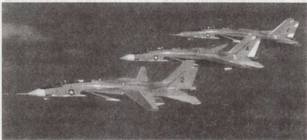
■ 2号、4号和IX号原型机，此时可见它们的机翼后掠角度各不相同。
