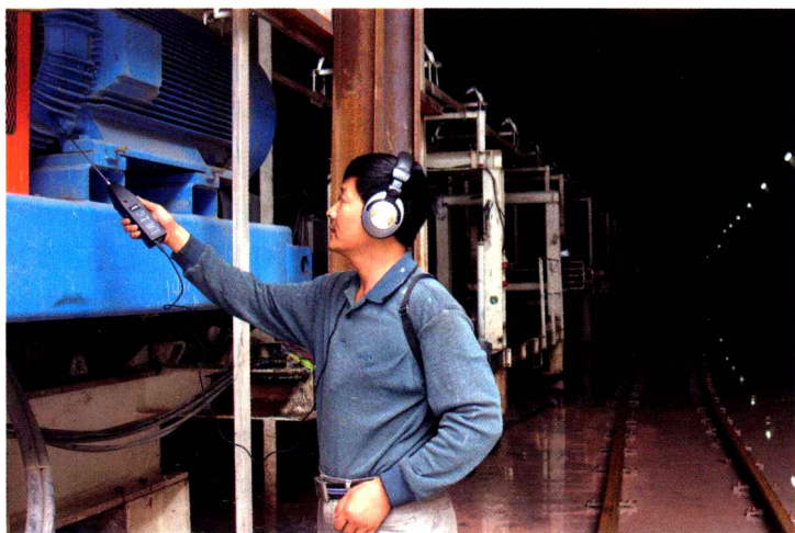
图 1-1 利用机械故障听诊器判断运行故障
