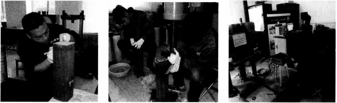
图 1.7 钢管约束混凝土柱分组试验
