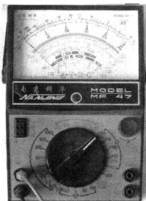
图 1-9 第一次测电容两极间阻值变化
