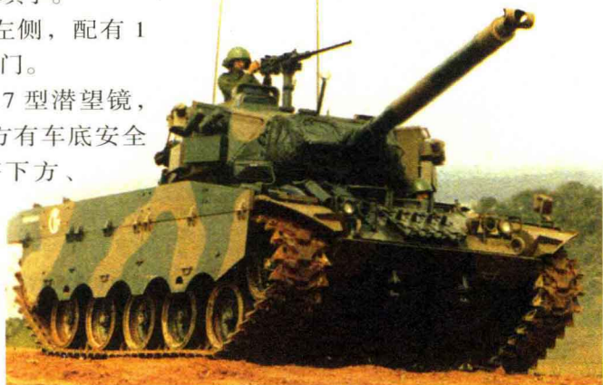
↑ M41 坦克炮塔制造结合了焊接与铸造技术，防护性能十分突出。
