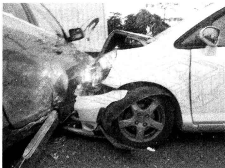
图 1-12 汽车直接损伤
