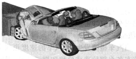
图 1-8 汽车正面与障碍物碰撞试验
