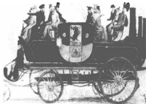
图 1-14 嘉内制造的第一辆蒸汽公共汽车
