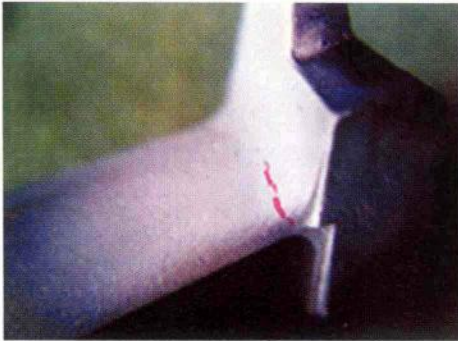
图52 镍基合金铸造涡轮叶片收缩裂纹 (着色渗透检测) [5]
