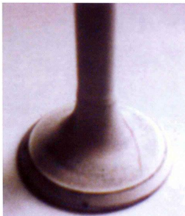
图 61 钢气门裂纹 (着色渗透检测)
