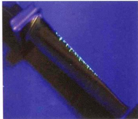
图 51 叶片进气边蚀损裂纹 （荧光渗透检测）
