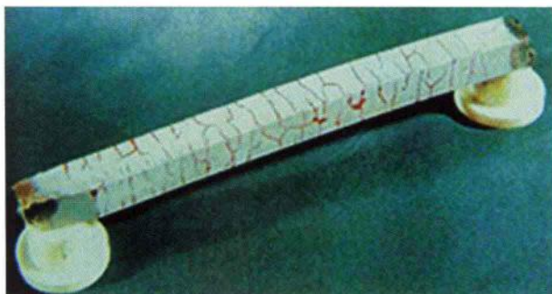
图 62 铸造钨棒沿晶裂纹 (着色渗透检测) [5]
