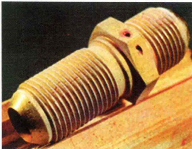
图 57 铝合金机加工双头螺栓纵向裂纹 (着色渗透检测) [5]
