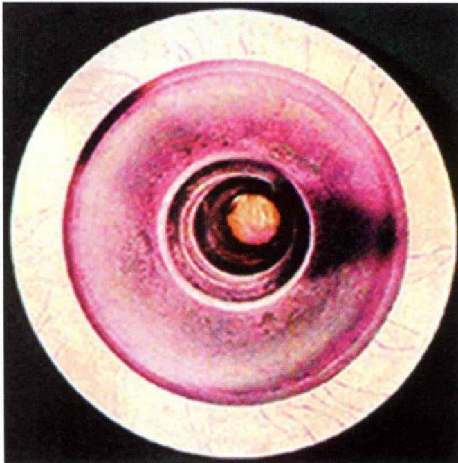
图54 45#钢轧辊端面磨削裂纹 (着色渗透检测) [5]
