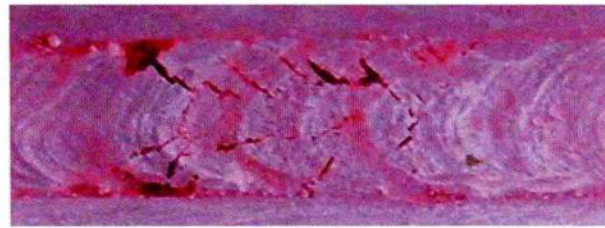
图67 手工电弧焊钢构件T焊缝上的八字裂纹 （着色渗透检测）
