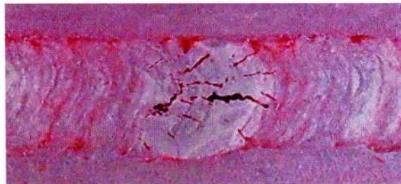
图68 手工电弧焊钢构件角焊缝上的弧坑裂纹 （着色渗透检测）
