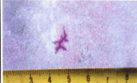
图53 铸钢件上的缩孔 (着色渗透检测)
