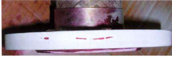
图 75 钢板车制法兰中的分层 (着色渗透检测)
