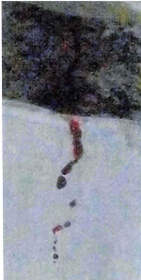
图 74 不锈钢铸坯表面缩裂 (解剖图) (着色渗透检测)
