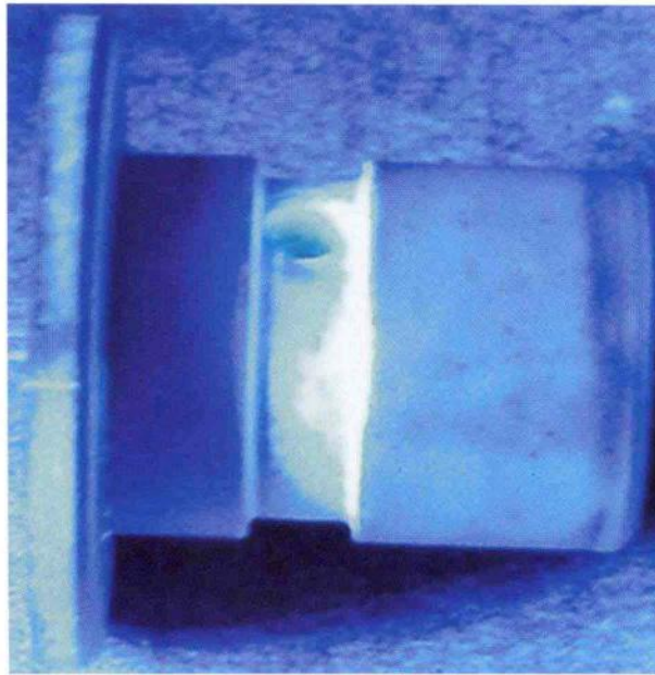
图 79 锻钢车制轴销底盘周面纵向裂纹 (荧光渗透检测)
