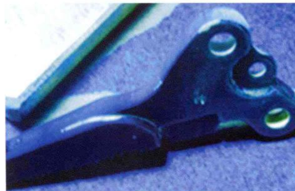
图 77 模锻钢齿杆切边裂纹 (荧光渗透检测)
