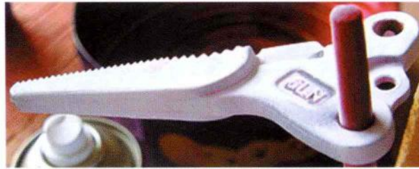
图 76 模锻钢齿杆切边裂纹 (着色渗透检测)
