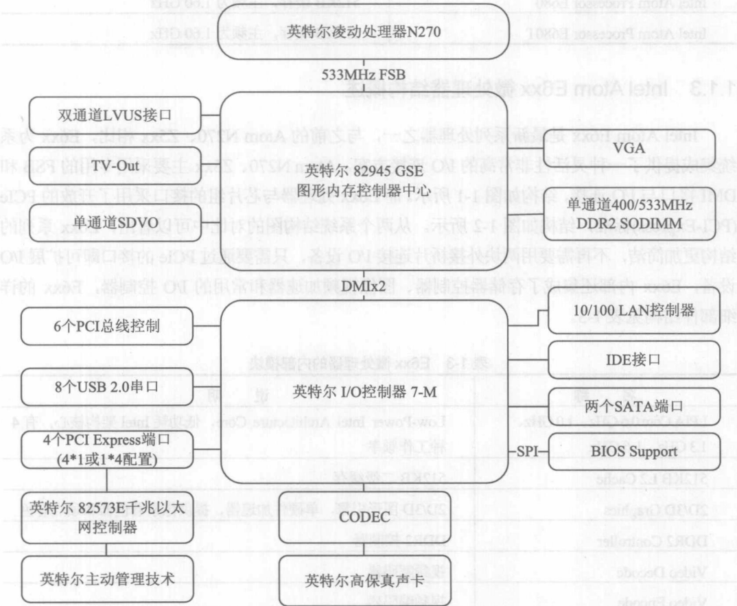
图 1-1 Intel Atom N270 微处理器的结构
