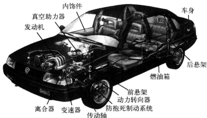
图1-1 桑塔纳2000GSi轿车整车透视图
