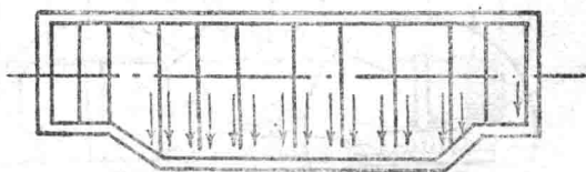
圖 5 連接縫的焊法
