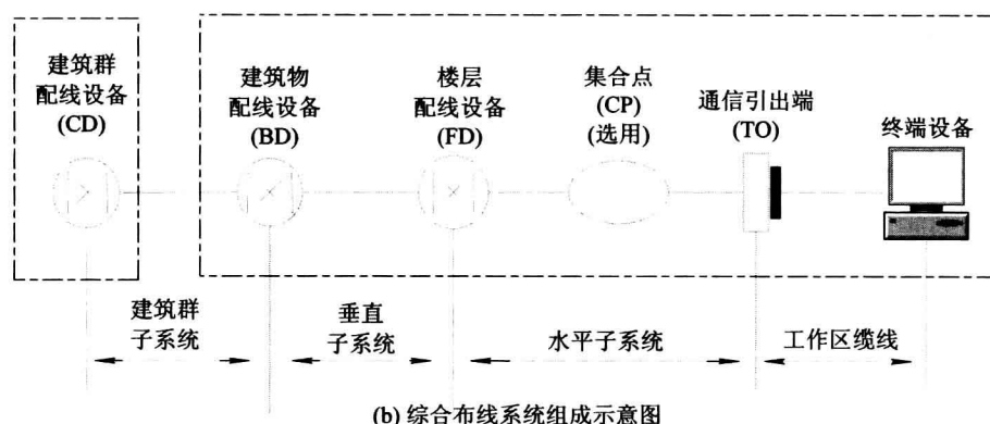
图 1.2 综合布线系统结构与组成(中国标准)
