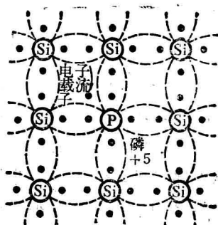
图 9-3 硅单晶体中掺磷形成电子型(N型)半导体
