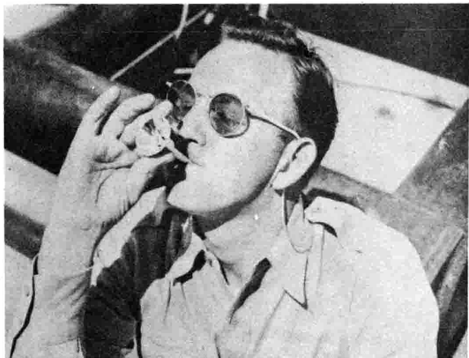
太陽高溫爐之原理。利用小型閃光燈之反射罩來點着香煙，香煙之前端置於反射罩之焦點，便能點火。
