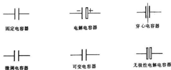
图 1-7 电容器的符号
