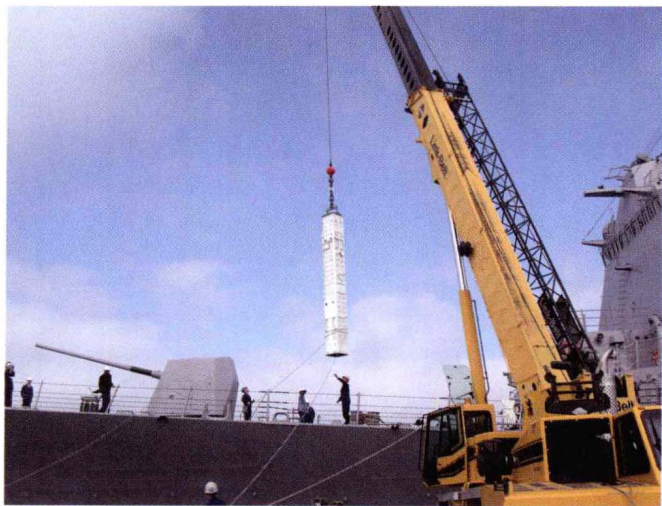
▲ 美国USS McCampbell(DDG-85)号的垂直发射器正在装填
