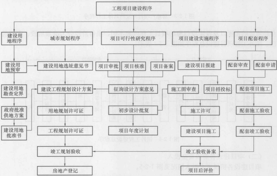
图 1-2-2 地方工程项目建设程序简图
