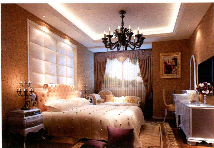
床头墙 [ 布艺软包 + 木线条刷白收口 + 墙纸 ]
