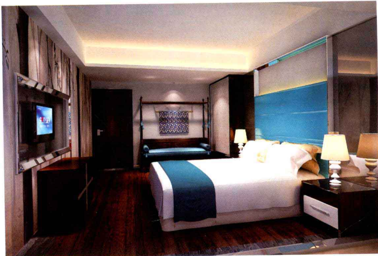
床头墙 [ 灰镜 + 布艺软包 + 不锈钢装饰条收口 ] 电视墙 [ 墙纸 + 灰镜 ]
