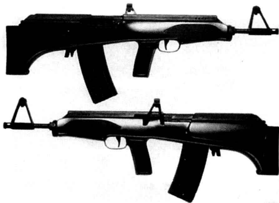
Valmet M82突击步枪，可以清晰地看到它的无托结构和左偏的瞄准装置
