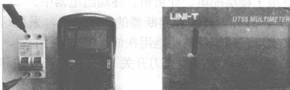
图 1.1.4 开关断开时检测 QF 主触点
