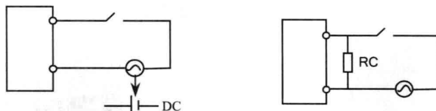
图 1-6 抑制输入感应电动势干扰的措施
