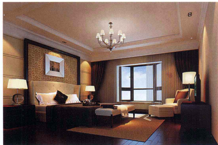
◎ 床头墙 / 墙纸 + 木线条收口 + 皮纹砖 电视墙 / 墙纸
