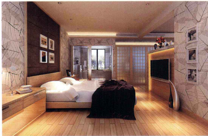
◎ 床头墙 / 布艺软包 + 墙纸 电视墙 / 木饰面板 + 大理石装饰框
