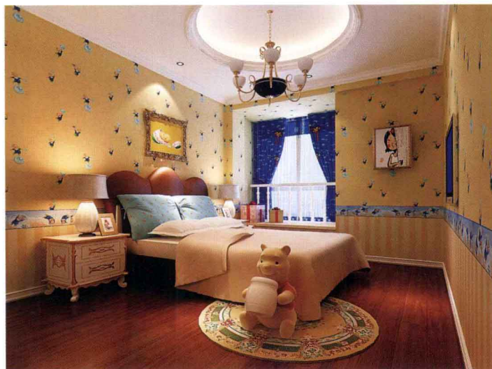
◎ 床头墙 / 墙纸 + 石膏顶角线 + 装饰腰线 地面 / 实木地板
