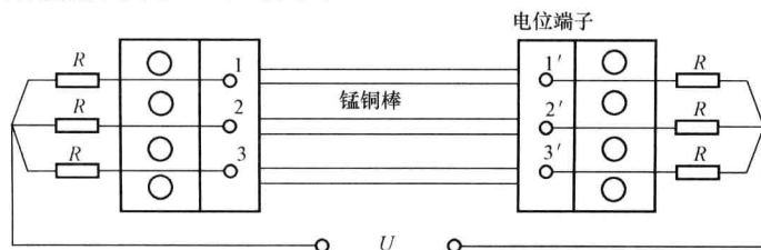
图 2-3 有 3 对电位端子的分流器接线图
