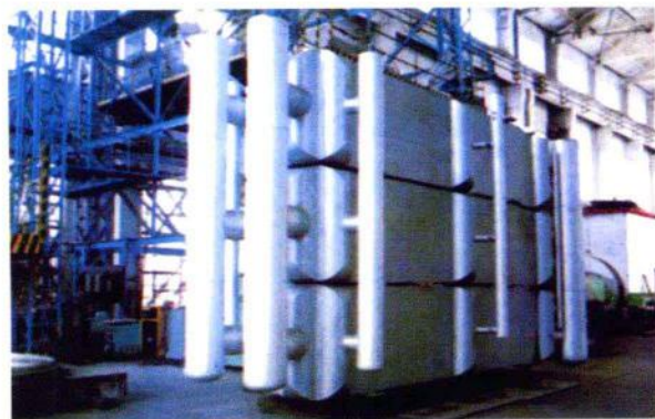
国内最大的组合板式换热器
